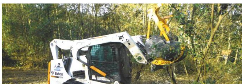
Las trituradoras TMC Cancela de la línea «W» cuentan con un diseño robusto y compacto con el fin de aportar una nueva utilidad tanto a los modelos más ligeros de minicargadoras hidráulicas, como a los más potentes. Su versatilidad nos permite llevar a cabo, desde las labores de limpieza y mantenimiento más básicas, hasta el triturado de ramas de gran diámetro y tocones, obteniendo un acabado de alta calidad. Fabricadas en acero de alto límite elástico Strenx®.
